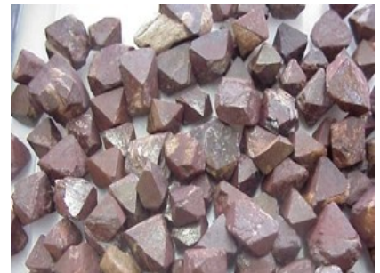
Magnetit als Gesteinskorn für Schwerbeton
